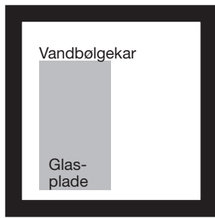
Figur 2. Vandbølgekar med ekstra glasplade i .
