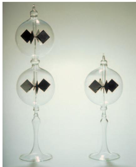
Dette er et såkaldt "radiometer". Navnets sidste del er lidt misvisende, idet et "meter" normalt er noget, man forbinder med måling. Det kan man ikke med dette apparat. Ordet radio betyder stråling – i dette tilfælde varmestråling.
