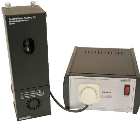
Spektrallampehusets stik tilsluttes drosselspolen i det 3-polet stik på fronten. Afbryderen på drosselspolen sluttet og spektralrørs lampen lyser op.
