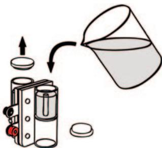
Destilleret vand påfyldes begge cylindre indtil vandet når toppen af det smalle rør i centrum af hver cylinder. Brændselscellen bankses forsigtigt mod bordet for at hjælpe vandet til at flyde ind i området omkring membranen og elektroderne. Tilsæt mere vand indtil vandet begynder at løbe ned i det lille rør i midten af cylindrene. Cylindrene tilproppes igen – vær opmærksom på, at propperne slutter tæt. Der må ikke være luft fanget inde i cylindrene.
