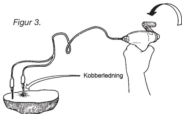
Drej godt til på håndtaget i ca. 30 sekunder. Læg så mærke til, at der dannes en blå-grøn farve omkring den ene ledning men ikke den anden. Denne farvedannelse sker kun på ledningen med en positiv spænding. Der er tale om kobberklorid, der dannes ved elektrolyse af salt ( $\text{NaCl}$ ), der naturligt forekommer i kartoffelsaften.
