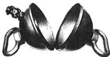
fig 6: De magdedurigske halvkugler (demonstrationsapparat i moderne udgave).
